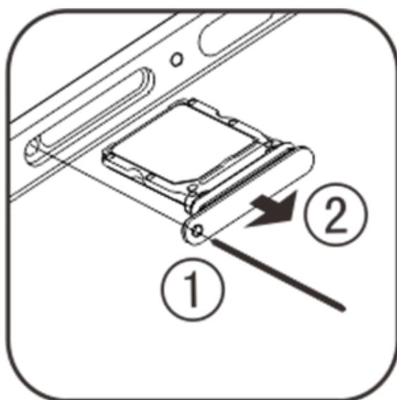
2. Siga la dirección de la flecha mostrada en el diagrama y coloque la esquina truncada de su tarjeta SIM en la esquina truncada de la bandeja.
