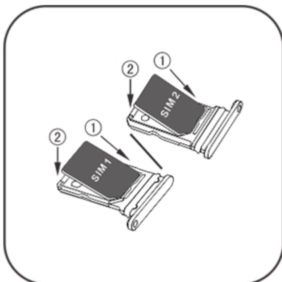
3. Con la pantalla táctil mirando hacia arriba, siga la dirección de la flecha para insertar la bandeja (con la tarjeta nano ) en el teléfono.
