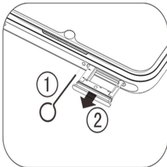
2. Seguí la dirección de la flecha mostrada en el diagrama y colocá la esquina truncada de tu tarjeta SIM en la esquina truncada de la bandeja.
