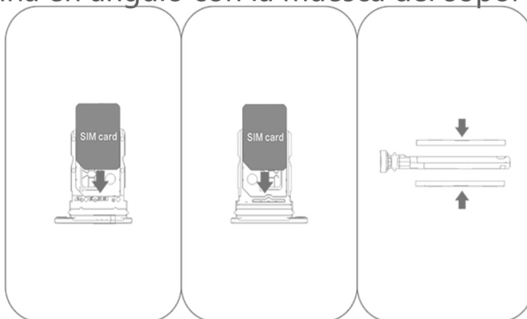
3. Coloque el dispositivo boca arriba y deslice la bandeja hasta el fondo de la ranura en la dirección que indica la flecha.
