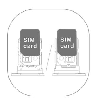
3. Con la pantalla táctil mirando hacia arriba, siga la dirección de la flecha para insertar la bandeja (con la tarjeta nano ) en el teléfono.
