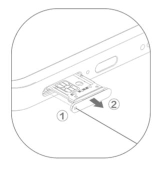
2. Siga la dirección de la flecha mostrada en el diagrama y coloque la esquina truncada de su tarjeta SIM en la esquina truncada de la bandeja.
