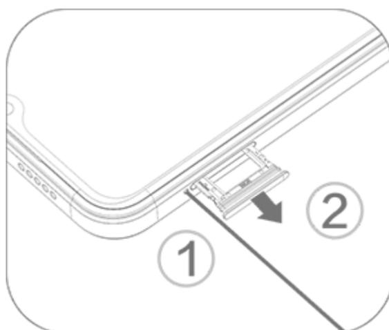
2. Coloque la tarjeta nano-SIM en el soporte SIM 1 o SIM 2 en la dirección de la flecha, como se muestra en la imagen. Asegúrese de alinear la esquina en ángulo con la muesca del soporte.
