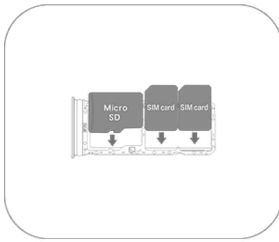
3. Coloque el dispositivo boca arriba y deslice la bandeja hasta el fondo de la ranura en la dirección que indica la flecha.
