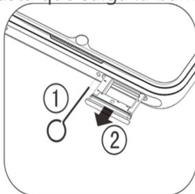
2. Sigue la dirección de la flecha mostrada en el diagrama y coloca la esquina angular de tu tarjeta SIM en la esquina angular de la bandeja.
