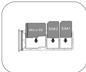
3. Con la pantalla táctil mirando hacia arriba, siga la dirección de la flecha para insertar la bandeja (con la tarjeta nano o Micro SD) en el teléfono.
