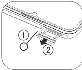
2. Coloque la cara metálica de la tarjeta nano (SIM1/SIM2) o de la tarjeta Micro SD hacia abajo, con el ángulo oblicuo alineado con el de la bandeja de tarjeta. Coloque la tarjeta nano (SIM1/SIM2) o la tarjeta Micro SD en la ranura de la tarjeta, con la orientación indicada por las flechas en el diagrama.
