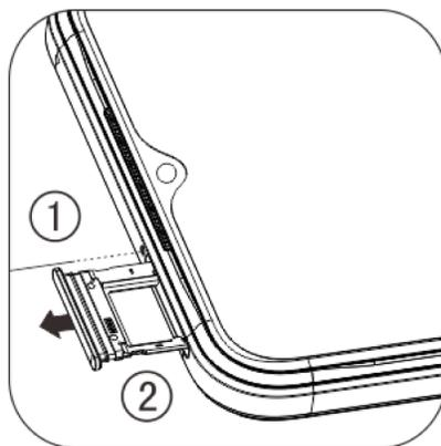
2. Fíjate en la dirección de la flecha del diagrama y haz coincidir la esquina angulada de la tarjeta SIM con la esquina angulada de la bandeja.
