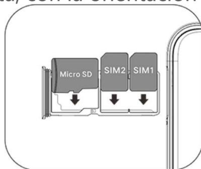
3. Con la pantalla táctil mirando hacia arriba, siga la dirección de la flecha para insertar la bandeja (con la tarjeta nano o Micro SD) en el teléfono.
